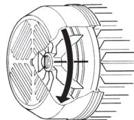
Prüfen, ob die Drehrichtung des Motors mit der Angabe auf dem Typenschild übereinstimmt (der Lüfter des Motors muß sich von hinten gesehen im UHRZEIGERSINN drehen). Bei einer Pumpe mit Dreiphasenmotor müssen bei falscher Drehrichtung zwei Phasen der Netzzuleitung am Schutzgerät vertauscht werden.
