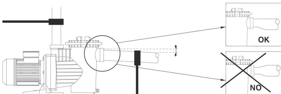
Es muy importante que las tuberías de aspiración e impulsión posean soportes independientes y queden bien fijadas para que de esta manera la bomba no soporte su peso ni las vibraciones producidas por el paso del caudal de agua a través de ellas. En caso de instalar una tubería de impulsión de gran longitud aconsejamos la instalación de una válvula de retención para evitar que el golpe de ariete producido por el retorno del agua al parar la bomba provoque algún desperfecto.
