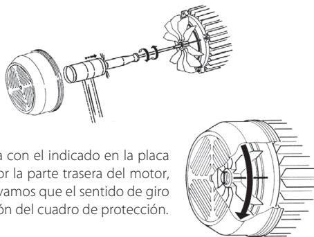
Compruebe que el sentido de giro del motor coincida con el indicado en la placa de características (el ventilador debe girar, mirando por la parte trasera del motor, en SENTIDO HORARIO). Si la bomba es trifásica y observamos que el sentido de giro es incorrecto se deben invertir dos fases de alimentación del cuadro de protección.
