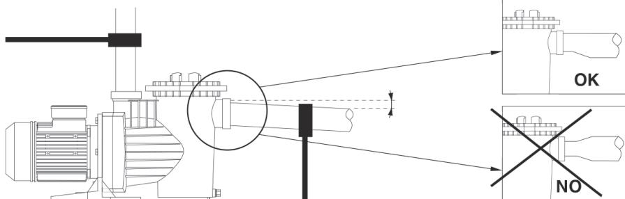
Es ist sehr wichtig, daß die Ansaugleitung über eigene Halterungen verfügt und gut befestigt ist, damit die Pumpe nicht das Gewicht der Rohrleitung tragen muß und nicht den durch die Wasserströmung bedingten Schwingungen ausgesetzt wird. Bei Ausführung mit einer langen Ansaugleitung empfehlen wir den Einbau einer Rückschlagklappe, um den bei Abschalten der Pumpe durch das rückströmende Wasser auftretenden Schlag zu verhindern, der zu Schäden an der Anlage führen kann.
