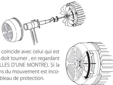
Vérifier que le sens du mouvement tournant du moteur coïncide avec celui qui est indiqué sur la plaque des caractéristiques (le ventilateur doit tourner, en regardant par le côté arrière du moteur, dans LE SENS DES AIGUILLES D'UNE MONTRE). Si la pompe est triphasique et que nous observons que le sens du mouvement est incorrect, il faudra inverser deux phases d'alimentation du tableau de protection.
