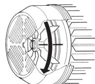
Verificare che il senso di rotazione del motore coincida con quello indicato sulla targhetta delle specifiche tecniche (la ventola deve ruotare, guardando dalla parte posteriore del motore, in SENSO ORARIO). Se la pompa è trifase e si osserva che il senso di rotazione è errato, si dovranno invertire due fasi di alimentazione del quadro di protezione.
